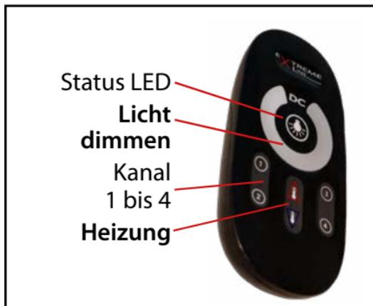
Achtung: Der Handsender schaltet nach einer kurzen Zeit auf Standby um die Batterien zu schonen. Das Aufwecken erfolgt über die Kanaltaste. Verwenden Sie unbedingt zusätzlich die Hauptbedienungsanleitung Ihres Gerätes. Decken Sie die Fernbedienung nicht ab oder legen Sie diese nicht mit der Bedienseite nach unten auf eine Fläche. Die Fernbedienung kann ansonsten ungewollt senden.
